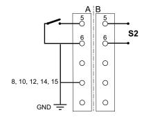
Fig. 4: Logic output wiring
