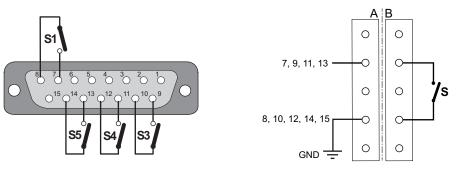
Fig. 3: Logic input wiring
